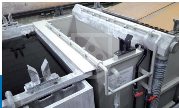
**Schnelle Fertigung:** Zwei Spülwasserbehälter aus Polystone® P CubX® für eine Eloxal-Anlage. Mit Polystone® P CubX® war ein vollständiger Verzicht auf Stahlverstärkungen und die damit verbundenen zeitaufwendigen Schweißarbeiten möglich
