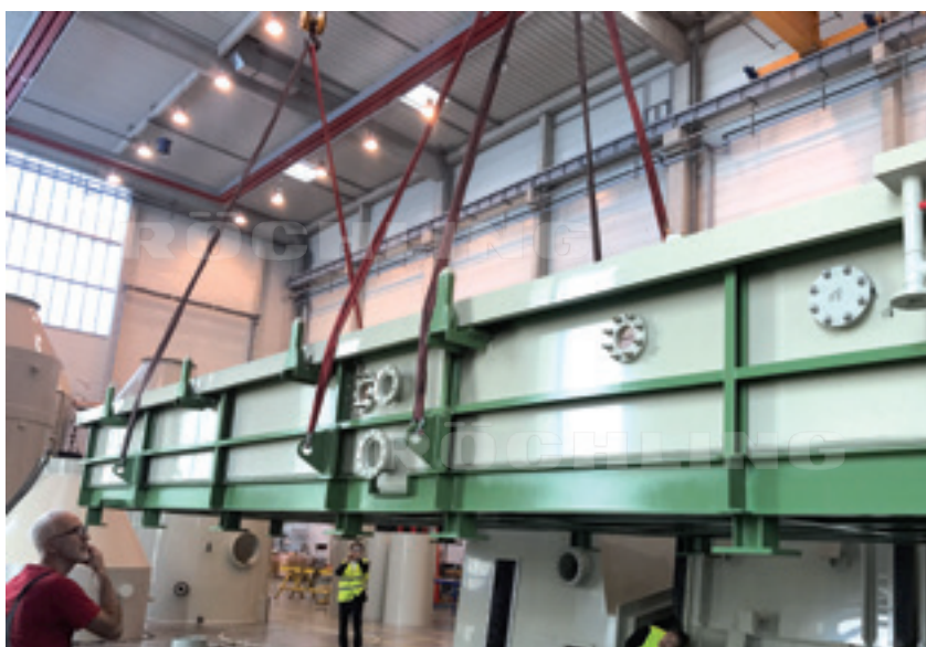
Polystone® P homopolymer šedá EHS Vysokoteplotně stabilizovaný polypropylenový homopolymer pro mořírnu oceli
