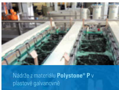
Polystone® P homopolymer šedá Nádrž pro zařízení k poměďování
