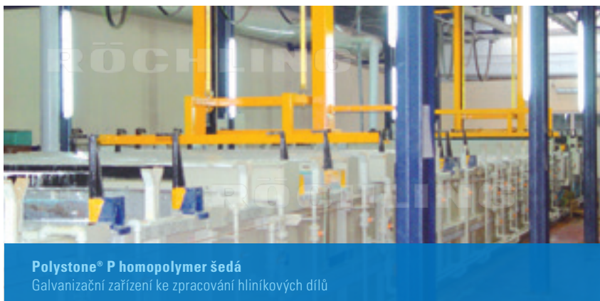
Nádrže z materiálu Polystone® P v plastové galvanově
