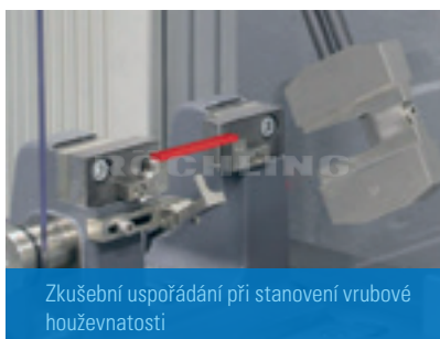
Přístroj ke stanovení vrubové houževnatosti
