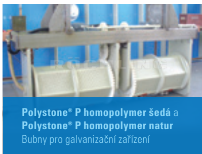
Polystone® P homopolymer šedá Galvanizační zařízení
