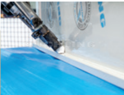
标准设备: 用于监测泄露的凹槽
