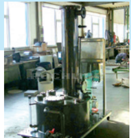
Polystone® G EL black 废气洗涤器
